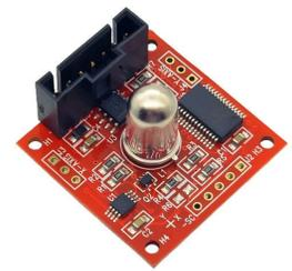
**±60° RS-232 Dual-Axis Inclinometer**
