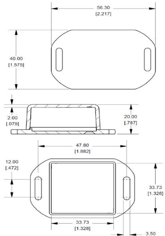
**±60° Analog Dual-Axis Inclinometer**
